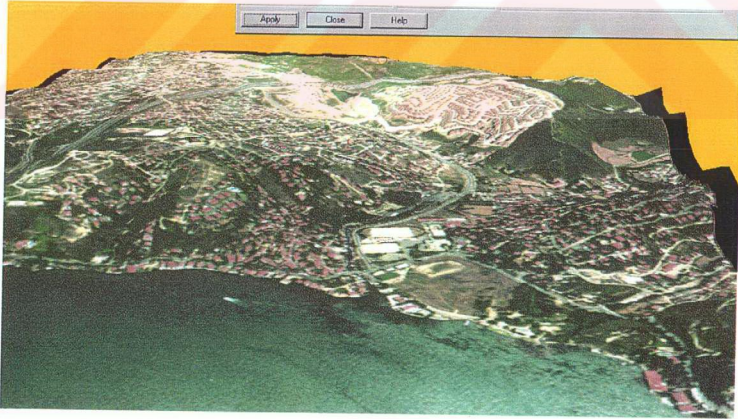
1 Metreye resampling yapılmış 1/5000 ölçekli ortofotolar (F22D17A ve F22D17B) ile 1/25000 ölçekli topoğrafik haritalardan oluşturulan İstanbul Boğazı dijital üç boyutlu görüntüleri
