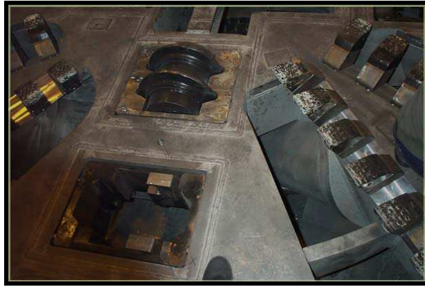
Şekil 2.8: Farklı Formasyonlara Sahip Zeminlerde Kullanılan, Riper Dişler ve Disk Keskili TBM Tasarımı
