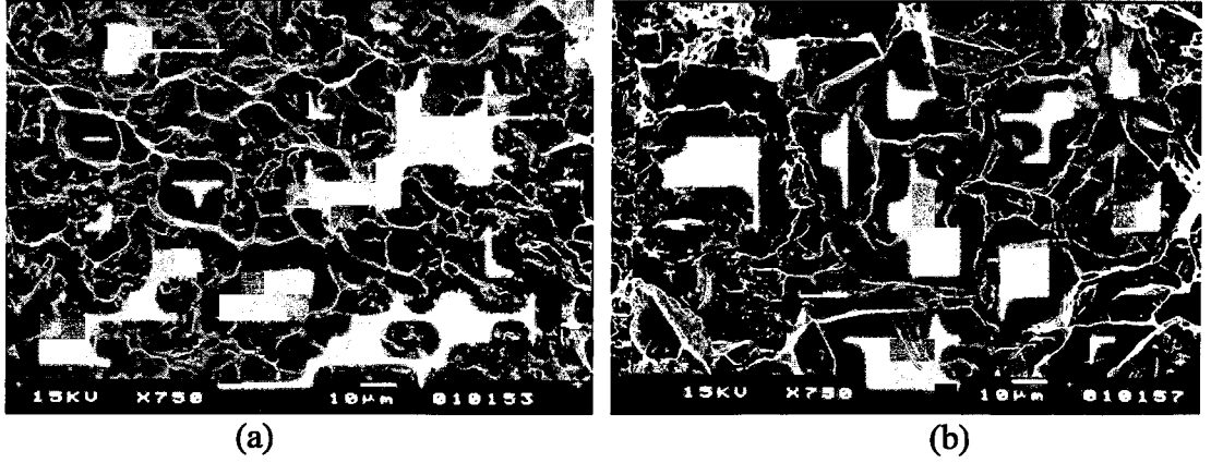
Şekil 7.13. (a) 13 \mu\text{m} ve (b) 37 \mu\text{m} SiC partikül takviyeli saf Al matrisli kompozit malzemelerin darbe deneyi sonrası kırık yüzey SEM görüntüleri.
