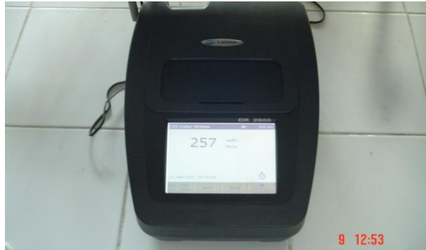
Şekil 3.3 : Renk ölçümünde kullanılan Hach Marka DR 2800 spektrofotometre.
