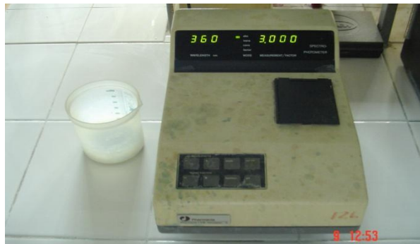
Şekil 3.4 : Renk ölçümünde kullanılan Pharmacia LKB, Novaspec II marka spektrofotometre.
