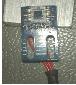
Şekil 4.13 : Pozisyon Duyarlı Fotodiyot (Hamamatsu S6695-01).
