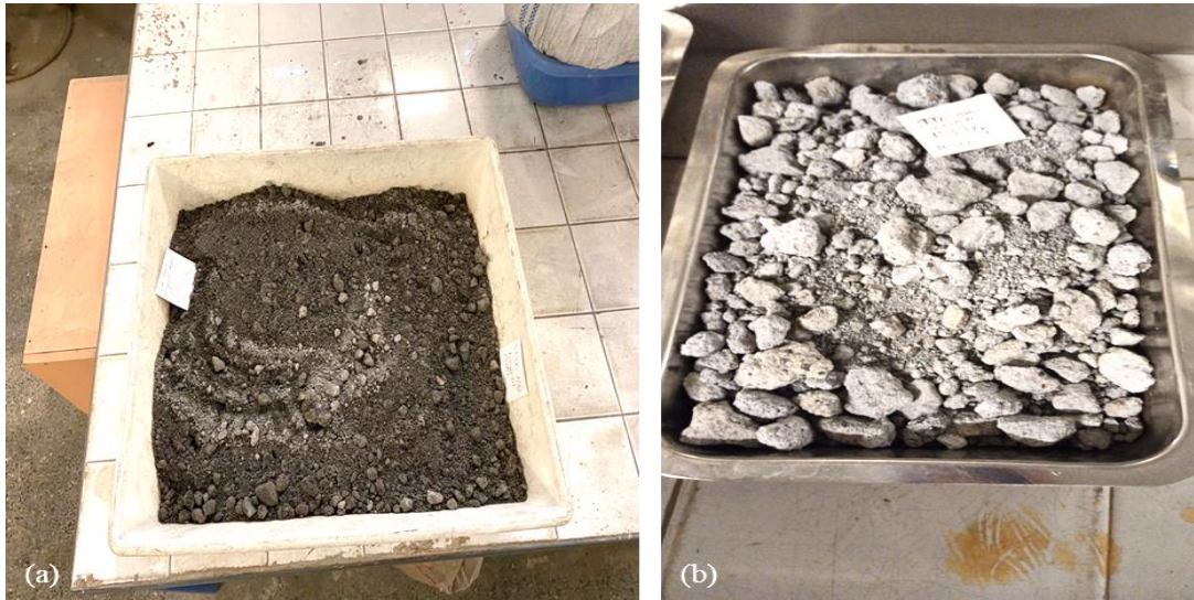
řekil 3.4: Temsili elek analizi ve kimyasal analiz numunesi (a); nem analizi uygulanan numune (b).
