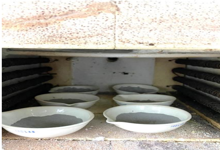
Şekil 3.12: ASTM D6357 standartına göre külleme işlemi yapılan taban külü numunesi.
