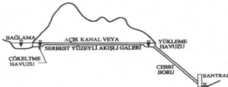
Şekil 4.1 : Biriktirmesiz hidroelektrik santral kesiti (Önöz, 2009).
