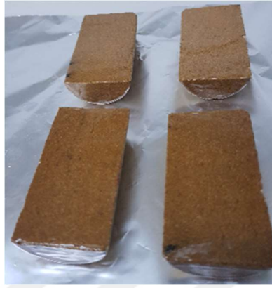
Şekil 4.3 : Kumtaşı kayaçlarından kesilmiş karot tapa örnekleri.
