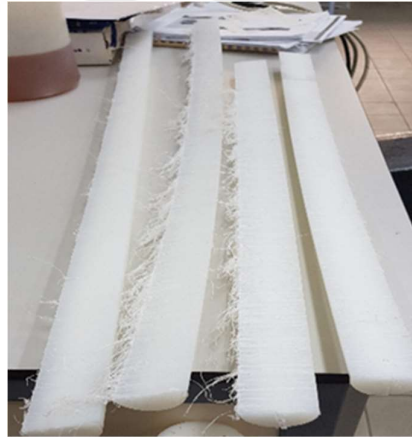
Şekil 4.2 : Poliamid çubukların sanayide kesilmiş karot tapa örnekleri.
