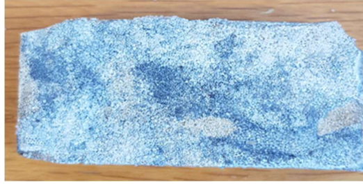
Şekil 4.6 : Hızlı yapıştırıcı ile yapıştırıcı kullanılan karot tapa örneğinin akış sonrası görüntüsü.
