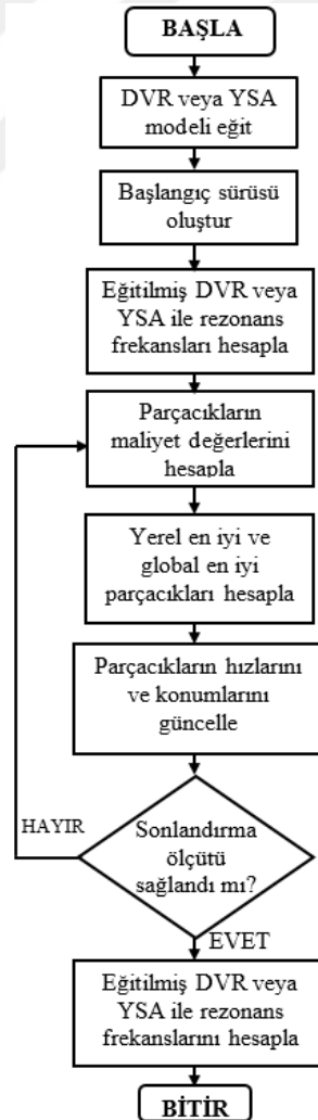
Şekil 4.17 : PSO tabanlı sentez prosedürü akış diyagramı.
