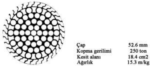
Şekil 5.8 Askı kablusu kesiti [11]
