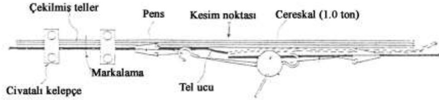
Şekil 6.36 Tel eklemeye detayı [23]
