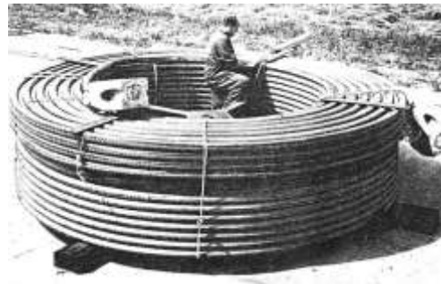
Şekil 5.3 35 ton ağırlığında kablo kolu sarılması.
