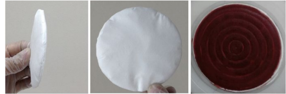
Şekil 2. Üretilen filtrenin filtrasyon öncesi ve sonrası görünümü
