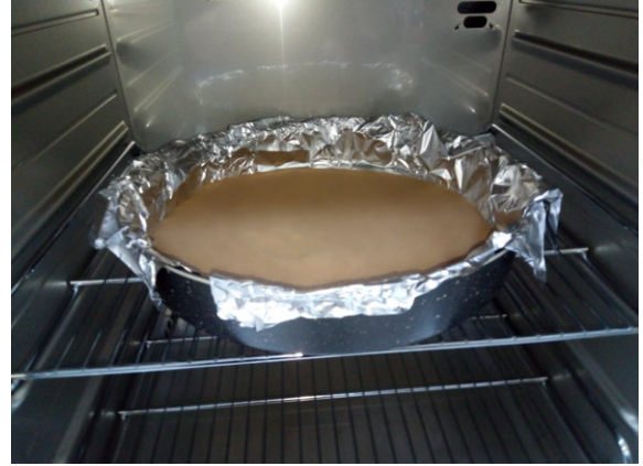
Şekil 5. 35-60 Mesh tanecik boyutuna ceviz kabuğu tozlarının etüvde kurutulması
