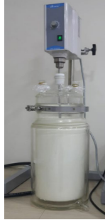
Şekil 1. Çift cidarlı reaktör içerisindeki nane yağı içerikli mikrokapsül çözeltisi
