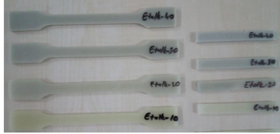
Şekil 7. Kalıplardan çıkarılan talk dolgulu epoksi numunelerinin resimleri
