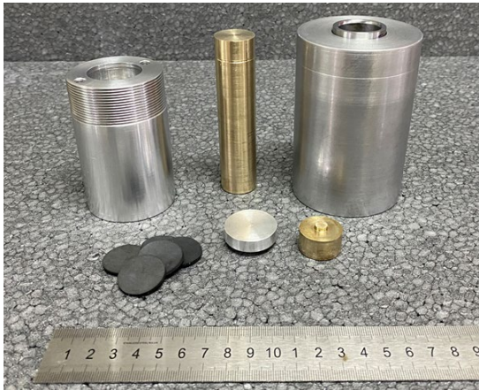
Şekil 2. Üretilen parçaların gerçek resimleri. Not: Kovan dışında bir alüminyum silindir (en sağda) ısı tutucu olması ve kovayı sabitlemesi amacıyla sonradan eklenmiştir.
