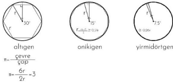
Şekil 2.10 : Pi ( \pi ) sayısının hesaplanmasında limit işlemi, Arşimet (MÖ 287-212).
