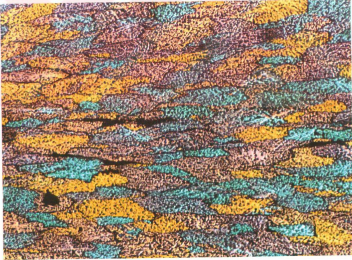
Şekil 7.2. Optik mikroskopta 50X büyütmede çekilen, 1 nolu numunenin döküm yönüne paralel kesit fotoğrafı.
