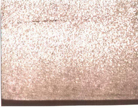
Şekil A3. 2 nolu numunenin 12X büyütmede döküm yönüne paralel kesit fotoğrafı ( merkezde segregasyonlar görülmektedir )
