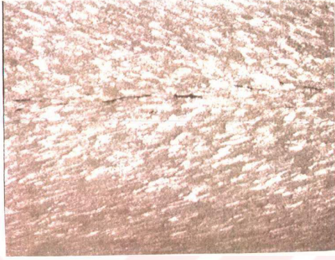
Şekil A1. 1 nolu numunenin 12X büyütmede döküm yönüne paralel kesit fotoğrafı ( merkezde segregasyonlar görülmektedir )
