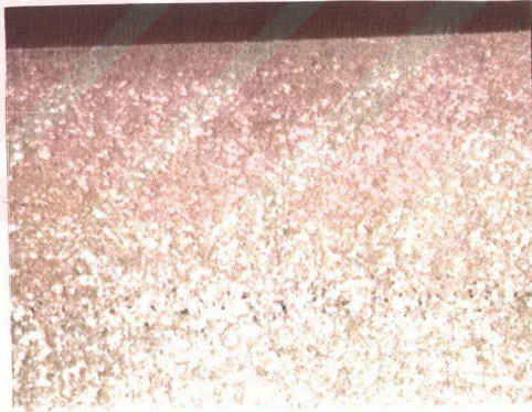
Şekil A2. 1 nolu numunenin 12X büyütmede döküm yönüne dik kesit fotoğrafı ( merkezde segregasyonlar görülmektedir )
