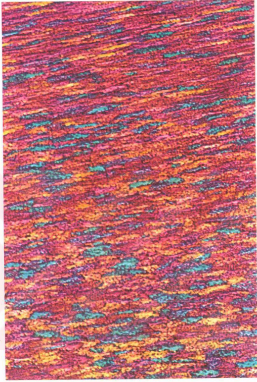
Şekil A9. 2 nolu numunenin 50X büyütmede döküm yönüne paralel kesitte merkez ile kenar arasındaki bölgenin fotoğrafı
