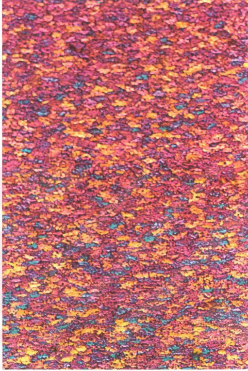
Şekil A10. 2 nolu numunenin 50X büyütmede döküm yönüne dik kesit fotoğrafı
