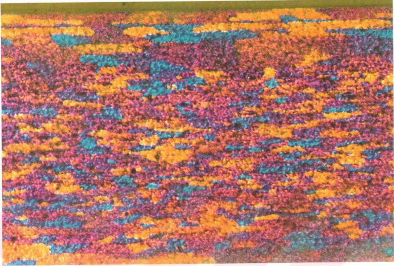
Şekil B3. 2 nolu prosesle üretilen 0,70 mm kalınlığındaki sacın 100X büyütmede hadde yönüne paralel kesit fotoğrafı.
