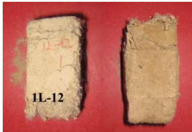
Şekil 5.62 : 48 saat suda bekletildikten sonra 1L-12 numunesi
