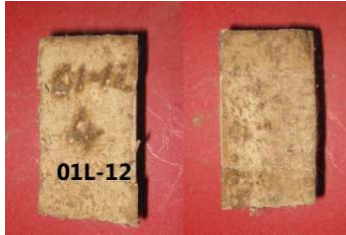
Şekil 5.43 : Kütlece %1 oranında 12mm uzunluğunda lif katkısı içeren 01L-12 numunesi
