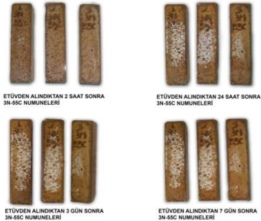
Şekil 5.21 : 3N-55C Serisinde Gözlemlenen Çizilme
