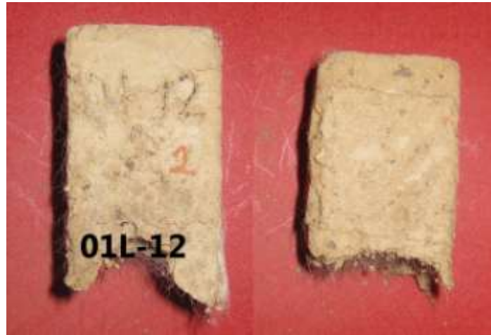
Şekil 5.56 : 48 saat suda bekletildikten sonra 01L-12 numunesi
