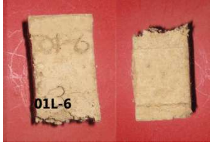
Şekil 5.54 : 48 saat suda bekletildikten sonra 01L-6 numunesi
