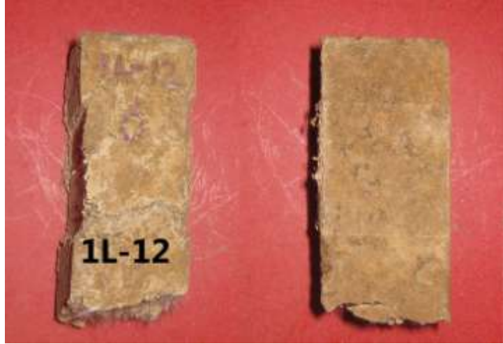
Şekil 5.49 : Kütlece %1 oranında 12mm uzunluğunda lif katkısı içeren 01L-12 numunesi
