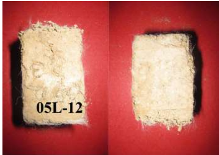
Şekil 5.59 : 48 saat suda bekletildikten sonra 05L-12 numunesi
