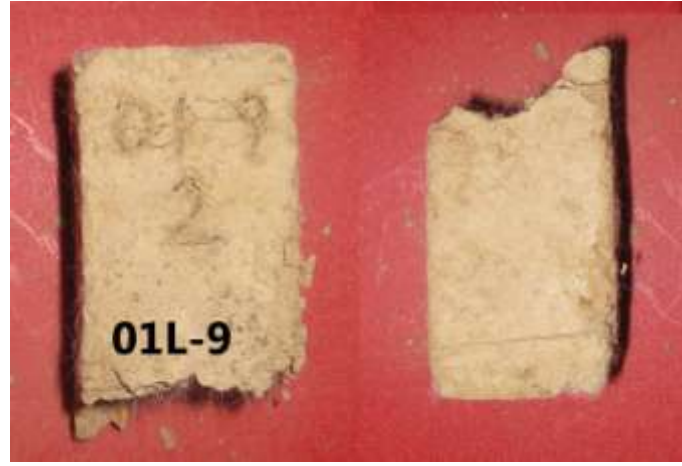
Şekil 5.55 : 48 saat suda bekletildikten sonra 01L-9 numunesi
