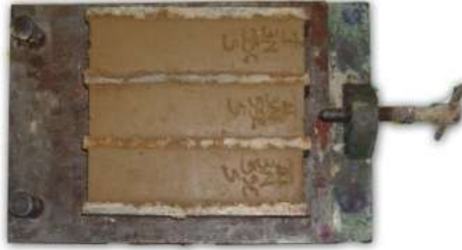
1 SAAT 55C'de KURLENDİKTEN SONRA KALIPTAN ALINAN 3N-55C-S NUMUNELERİ
