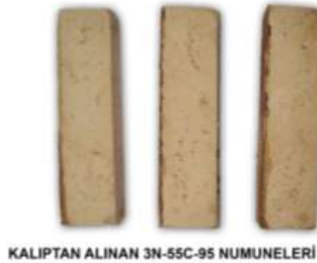
Şekil 5.19 : Etüvde Kalıp İçinde Kürlenene Numunelerin Yüzey Dokusu
