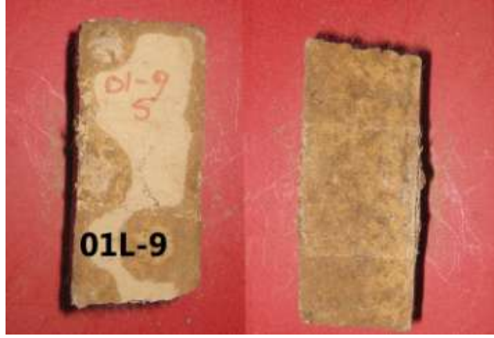
Şekil 5.42 : Kütlece %1 oranında 9mm uzunluğunda lif katkısı içeren 01L-9 numunesi
