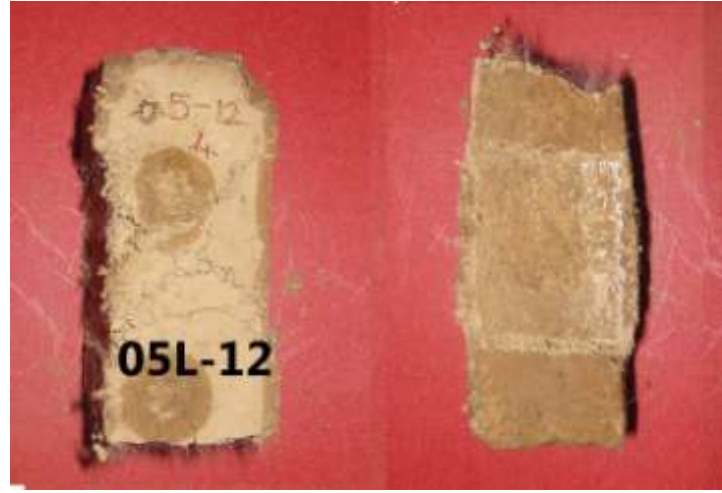
Şekil 5.46 : Kütlece 0.5% oranında 12mm uzunluğunda lif katkısı içeren 05L-12 numunesi
