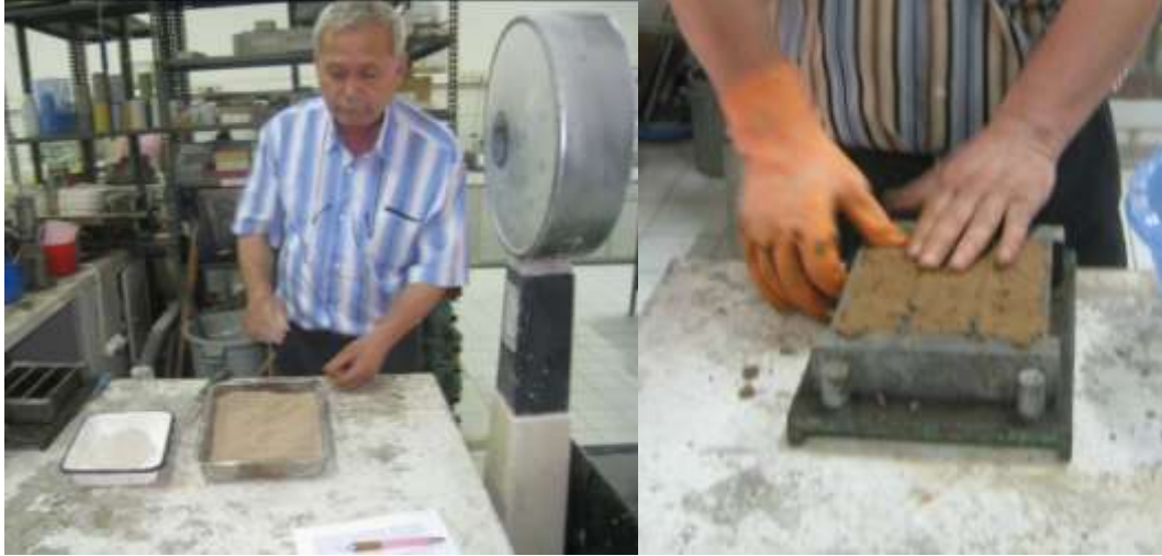
Şekil 5.5 : 2. Grup Numunelerin Hazırlanması ve Kalıplanması
