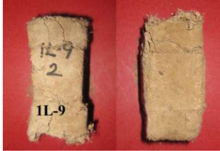
Şekil 5.61 : 48 saat suda bekletildikten sonra 1L-9 numunesi
