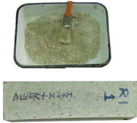
Şekil 5.17 : 24°C’de kürlenlen NaOH katlı Numunelerde Yüzey Dokusu.
