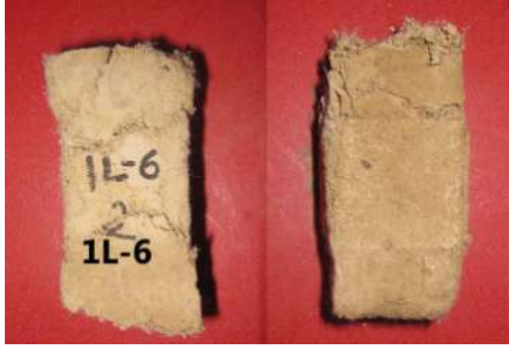
Şekil 5.60 : 48 saat suda bekletildikten sonra 1L-6 numunesi
