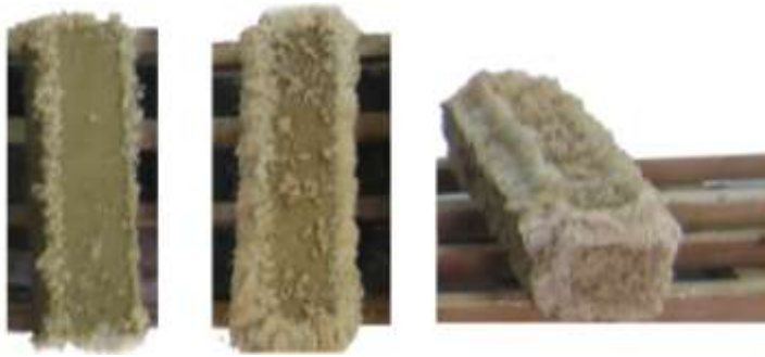
Şekil 5.16 : Yüzeyde gözlemlenen kasma
