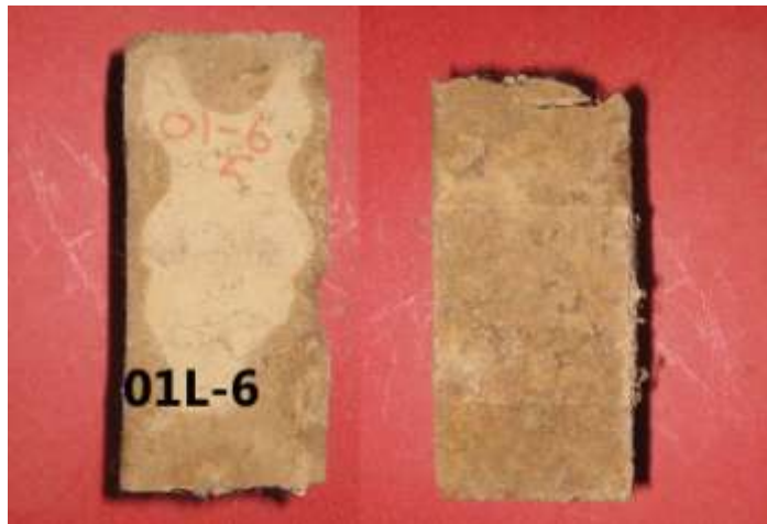
Şekil 5.41 : Kütlece %1 oranında 6mm uzunluğunda lif katkısı içeren 01L-6 numunesi
