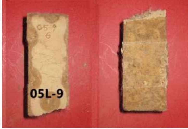
Şekil 5.45 : Kütlece 0.5% oranında 9mm uzunluğunda lif katkısı içeren 05L-9 numunesi
