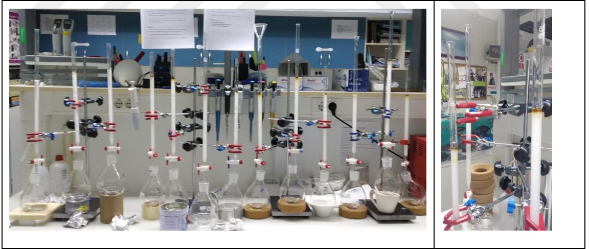
Şekil 2.3 (a) Silika kolonu ile saflaştırma işlemi (b) Silika kolonu ile saflaştırma işlemi yakın çekimi.
