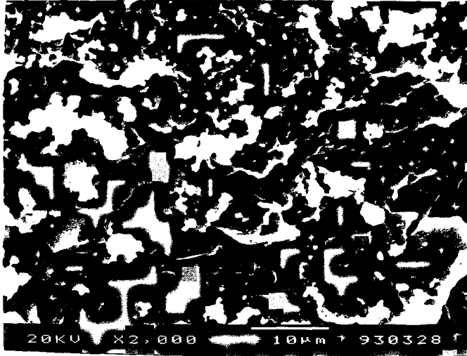
Şekil 4-32 Orijinal N3 linyit numunesinin SEM mikrografi (2000 büyütme)
