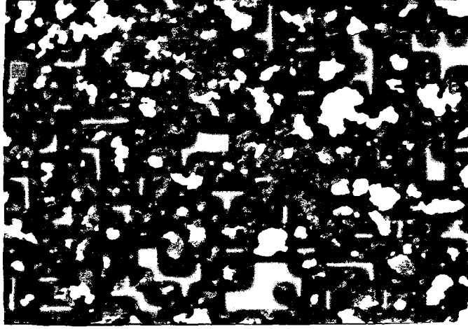
Şekil 4-4 6 \times 10^{-4} - 10^{-3} m orijinal kireçtaşı SEM mikrografi ( 2000 büyütme )
