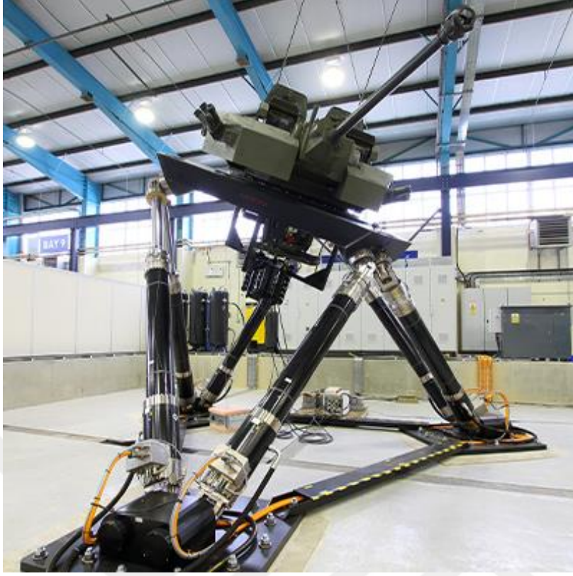
Şekil 1.12 : Stewart platformu üzerinde test edilen kule sistemi [8].
