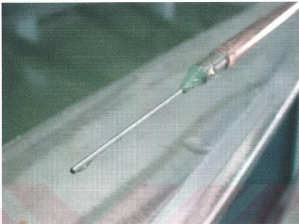
Fotođraf D.1- Siđil arkasında basınç ölçümünde kullanılan basınç probu.
