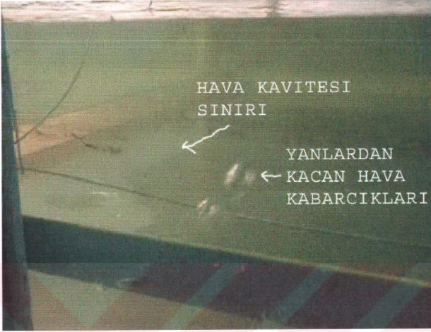
Fotograf C.1- Su hızı 0,6m/s hava veriş hızı 2,2m/s hava yanlardan kaçıyor, maksimum kavite boyuna ulaşılmış durumda. (30 derecelik sigil)
