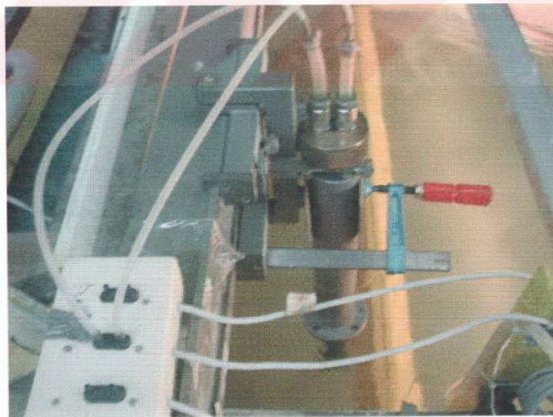
Şekil 4,3;Kanaldaki su hızının ölçümünde kullanılan pitot tüpü ve basınç algılayıcısı.
