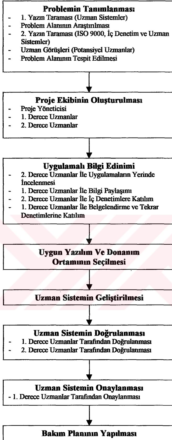
Şekil 5.13 Önerilen Uzman Sistem Yaklaşımının Geliştirme Süreci
