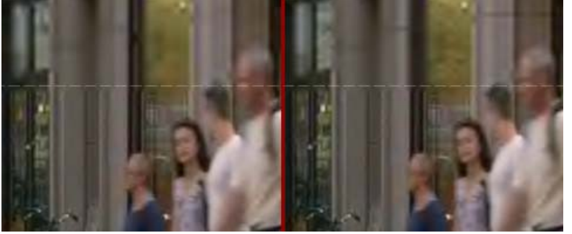
Şekil 4.14 : Ağırlıklandırılmış örtülü kodlama için ROI bölgesi - arkaplan geçişi. (“pedesterian” videosu çerçeve 55. Solda ağırlıklandırılmış yöntem, sağda örtülü kodlama, ROI %25, R_w=8 )
