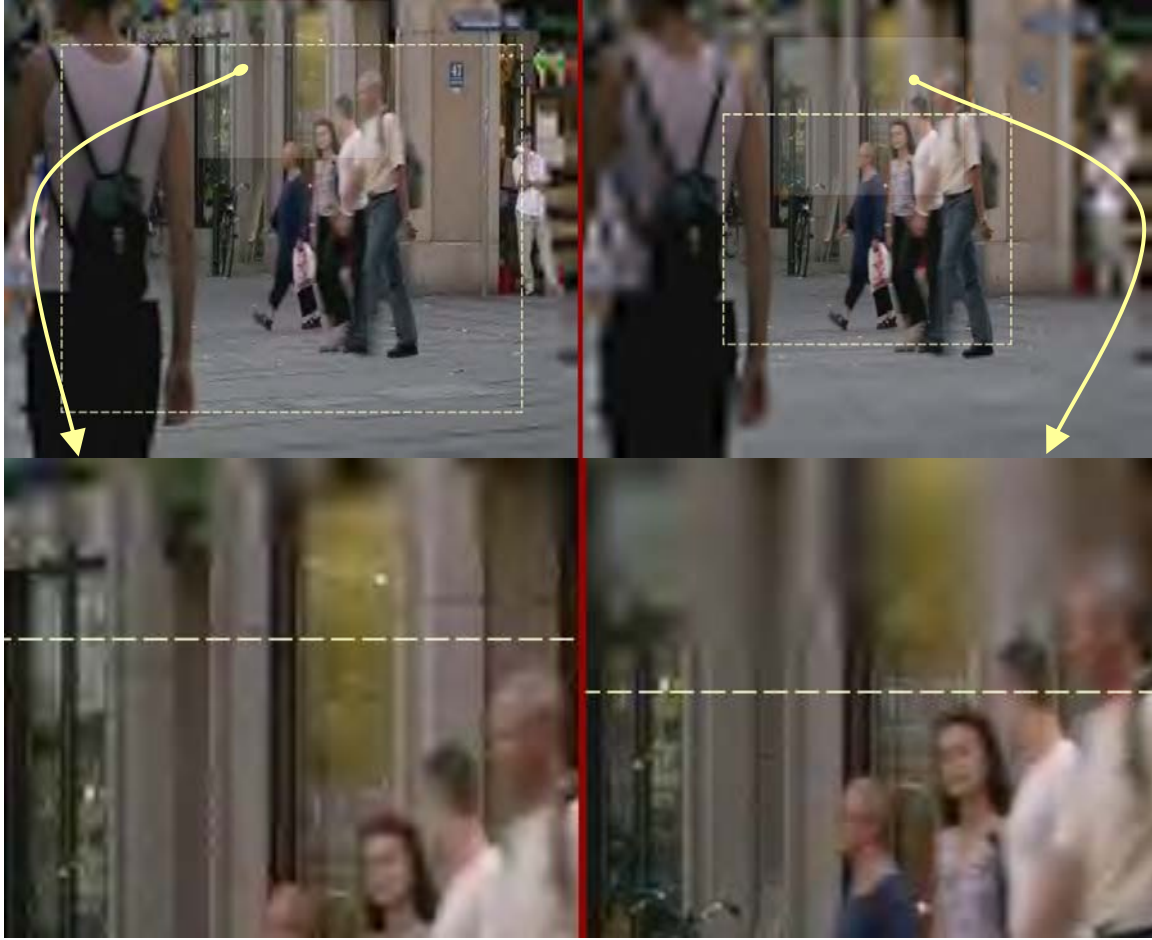
Şekil 4.4 : Maxshift ROI kodlama için önplan arkaplan geçişi. Solda %64'lük, sağda %25'lik ROI bölgesi, altta geçiş bölgesinin yakınlaştırılmış görüntüsü. (“pedesterian” video’su 55. çerçeve, 0,1 bit/piksel)
