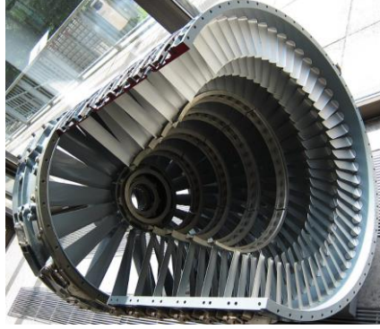
Şekil 2. 11: Kompresöre ait statorun kesit olarak gösterimi [38].
