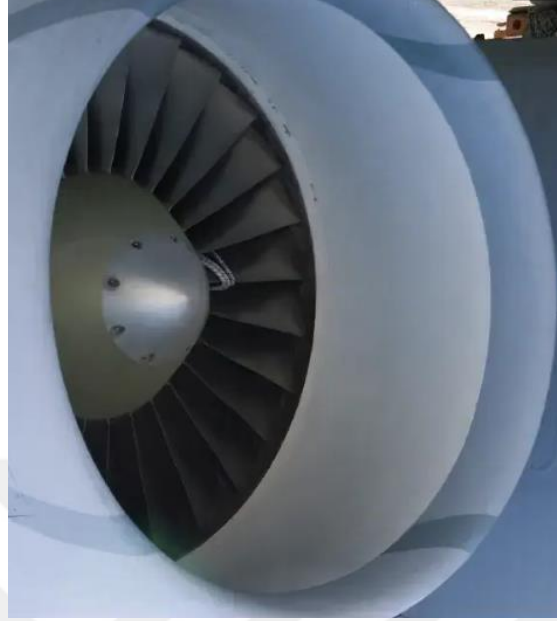
Şekil 2.7: Ticari turbofan motorlara ait bir hava alıđının perspektif görünüşü [36].
