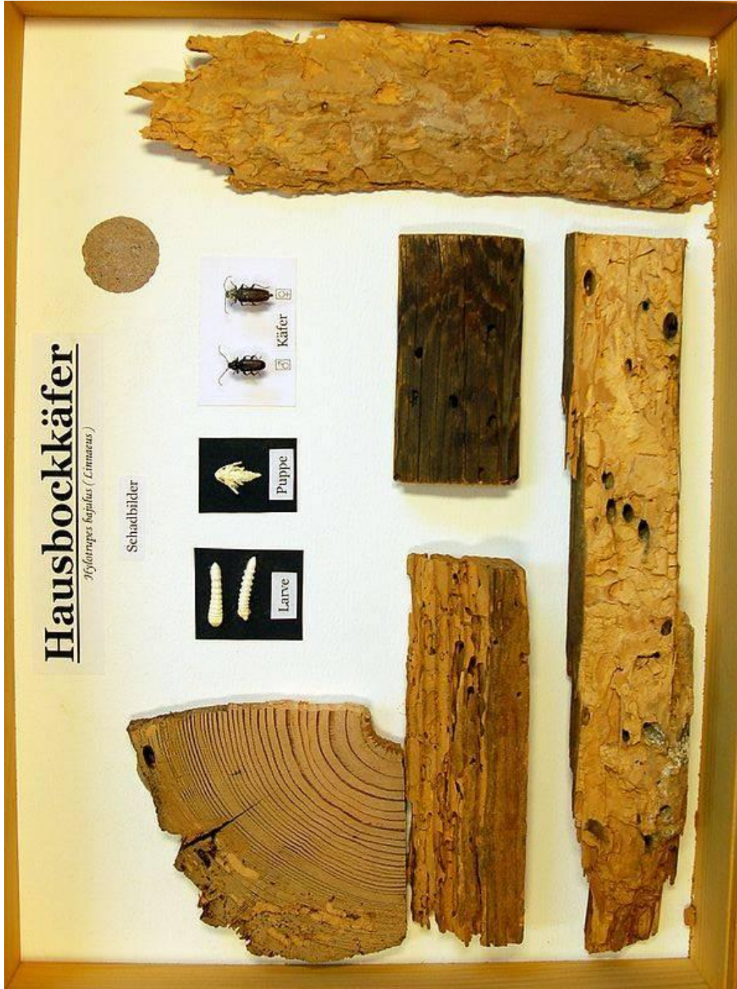
Şekil A.37 : Hylotrupes bajulus hasar ve u ma delikleri 103
