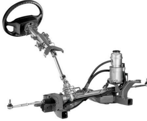
řekil 2.13 : Elektro Hidrolik Yönlendirme Sistemi [14]
