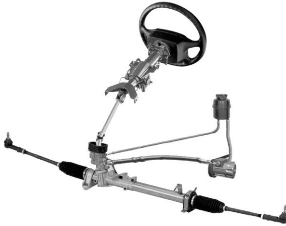
Şekil 2.10 : Hidrolik Güç Takviyeli Yönlendirme Sistemi [11]
