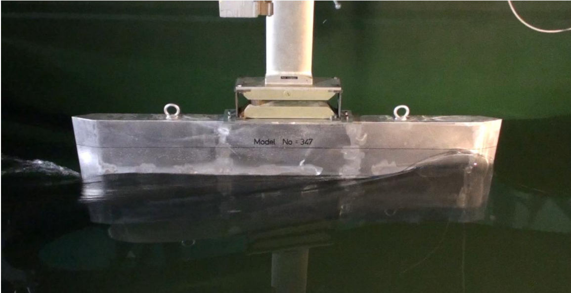
Şekil 6.6 : Levha 1, 41 cm draftta 2 m/s hızla çekiliyor.
