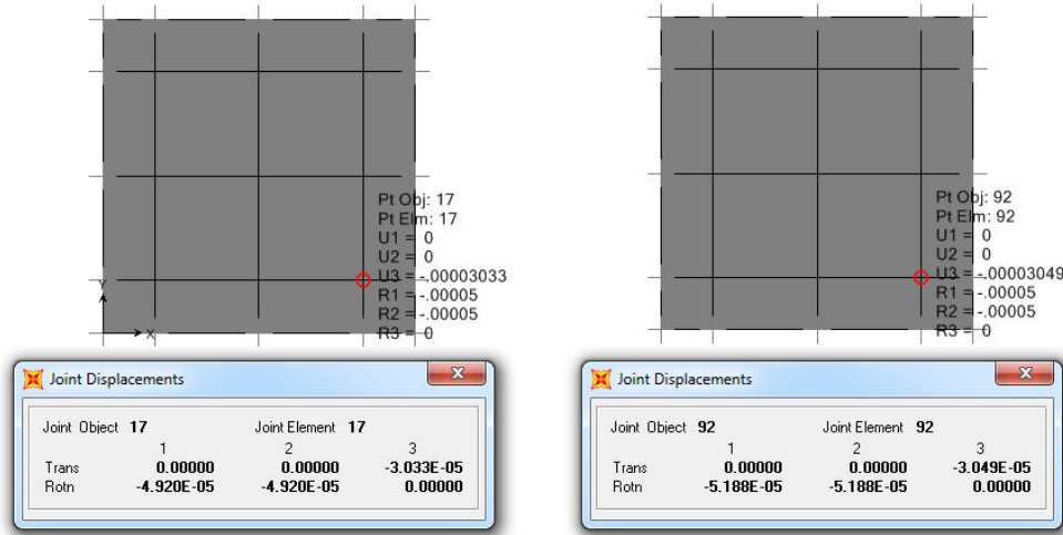
Şekil 4.3 : SAP2000’de kaset döşeme ve eşdeğer döşemenin karşılaştırılması.
