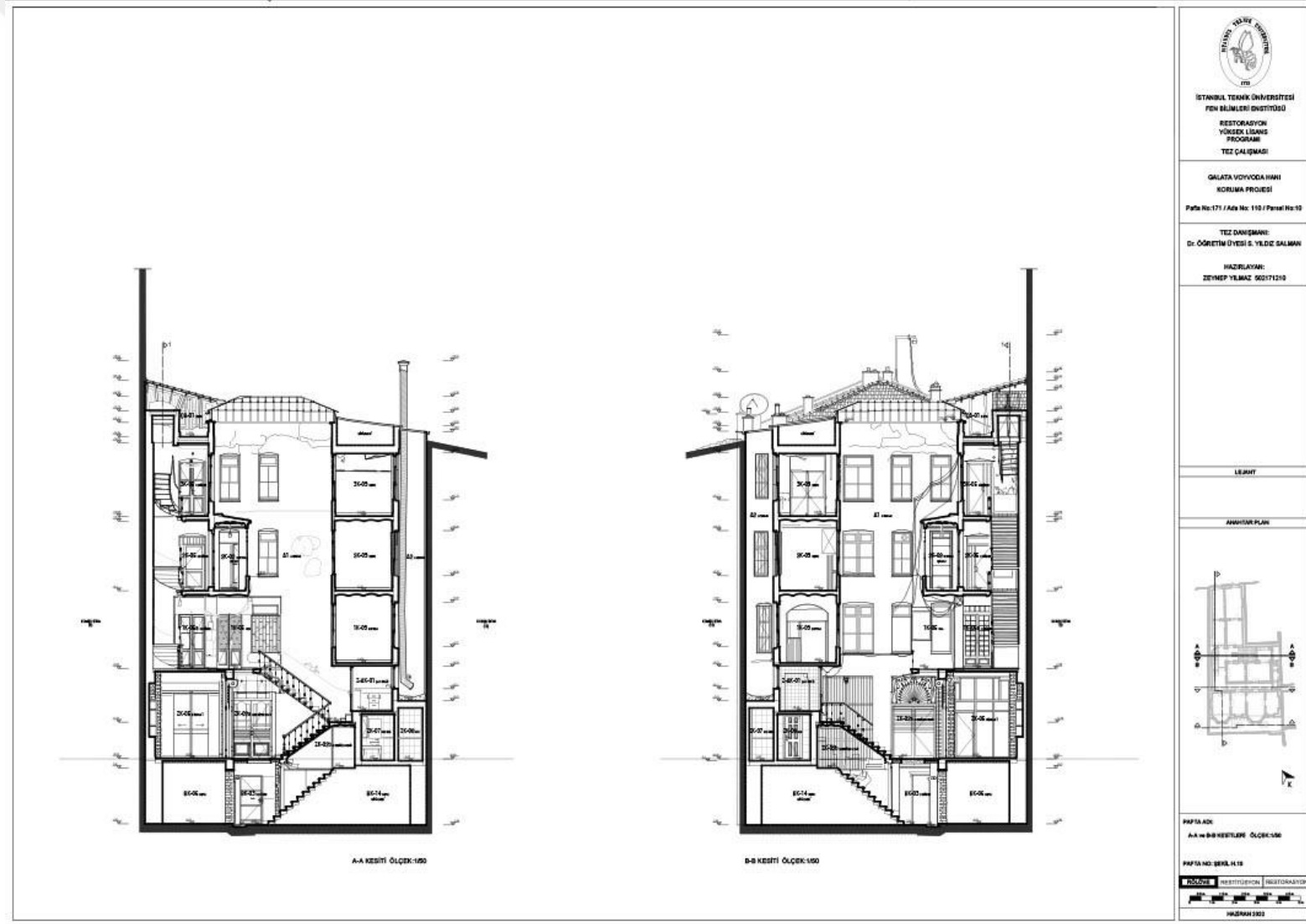
Şekil G.10 : Rölöve: A-A ve B-B kesitleri
