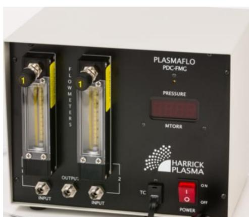
**Figure 3.10:** Gas Flow Mixer (PlasmaFlo).
