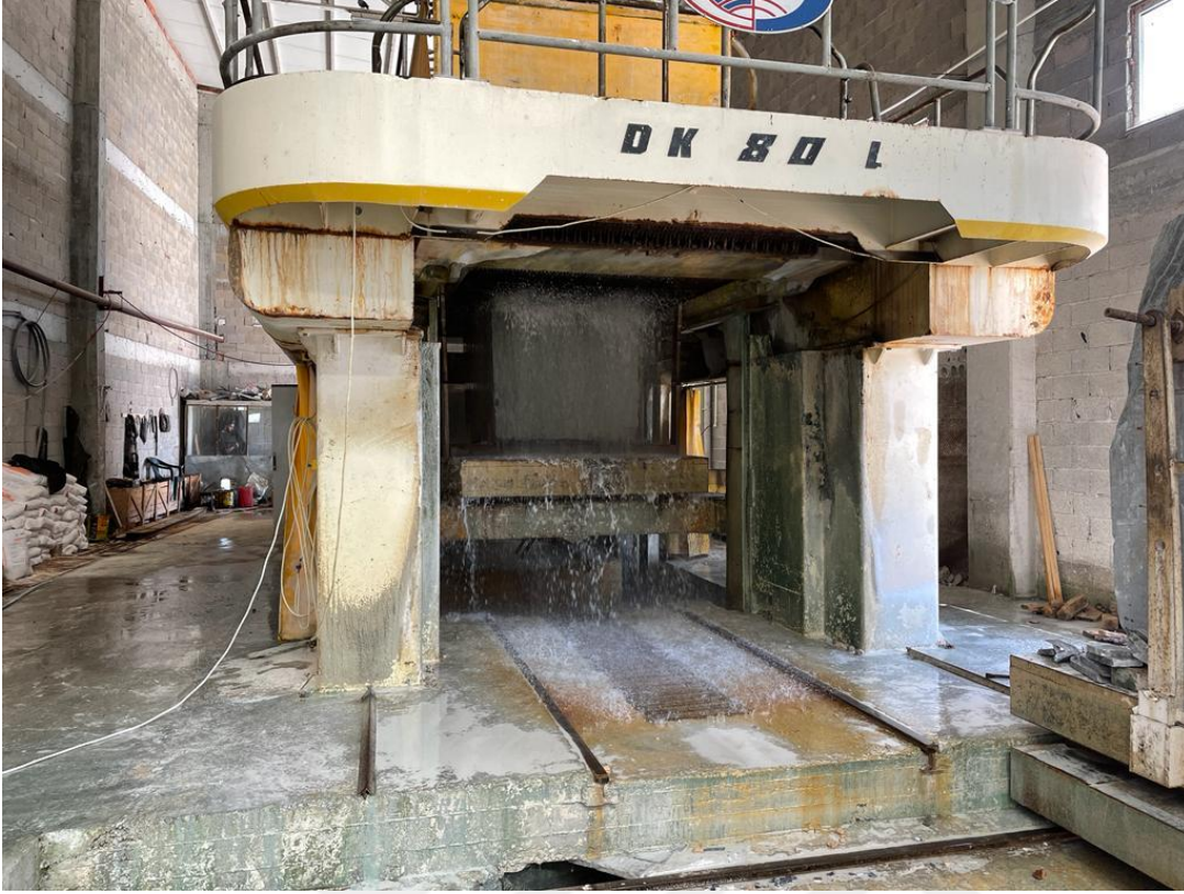
Şekil 3.1 : Kesim anında katrak makinesi.
