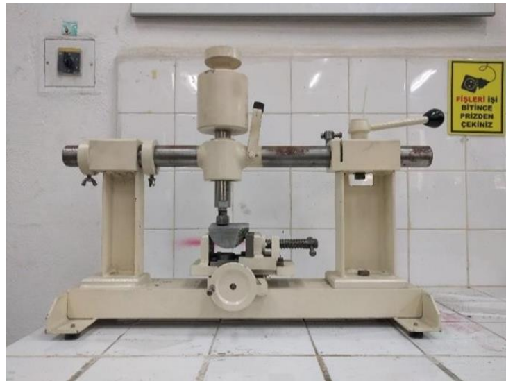
Şekil 6.10 : Bu çalışmada kullanılan Cerchar deney aleti.
