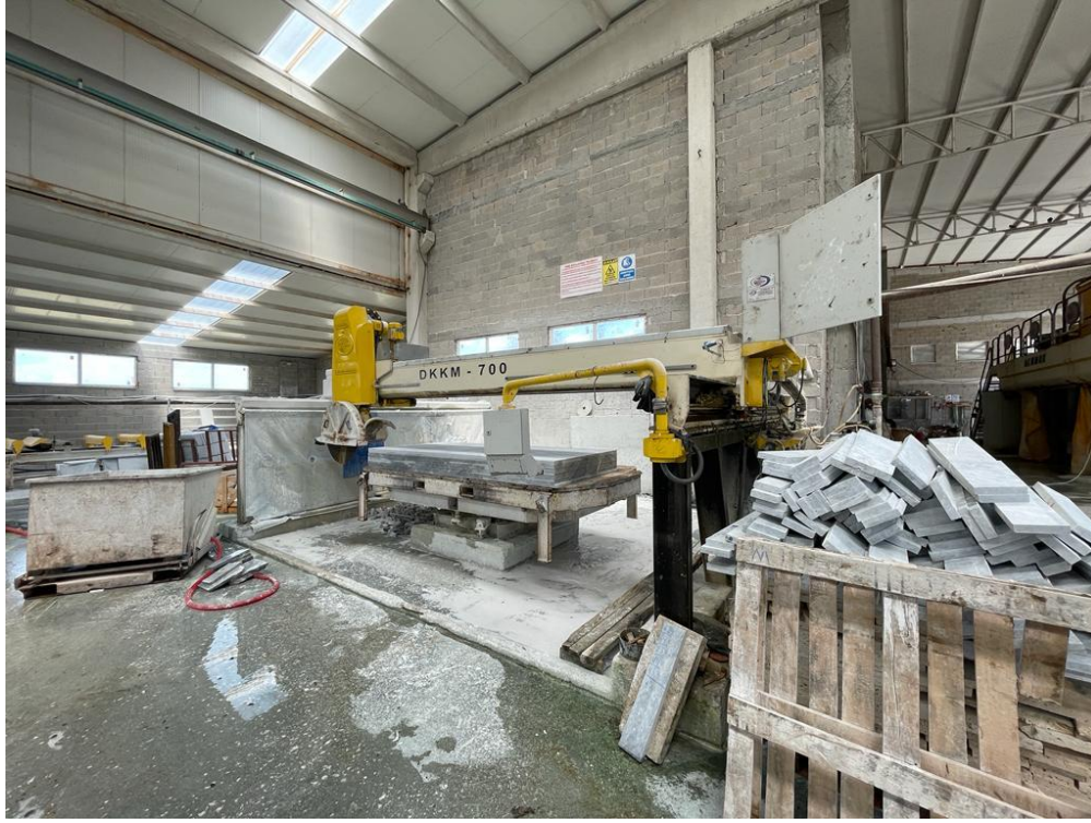
Şekil 3.3 : Köprü kesme makinesinde kesim.
