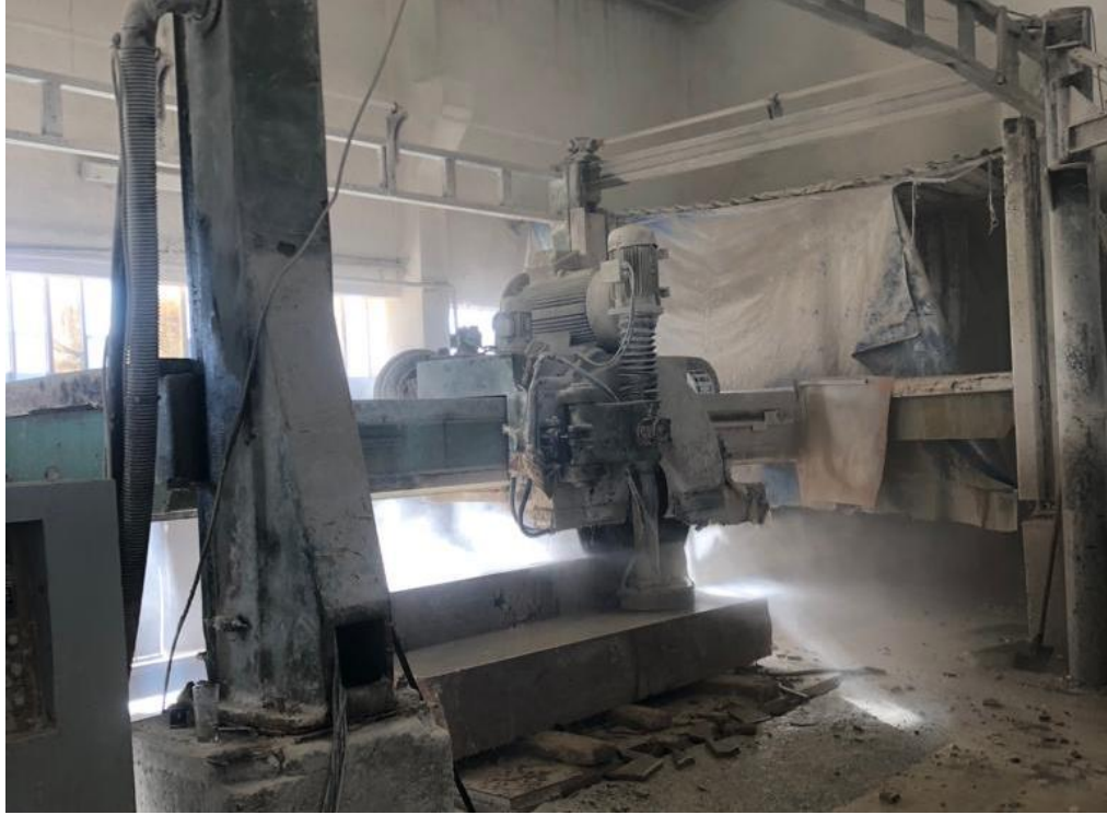
ř ekil 3.2 : S/T makinesi ile blok kesimi.
