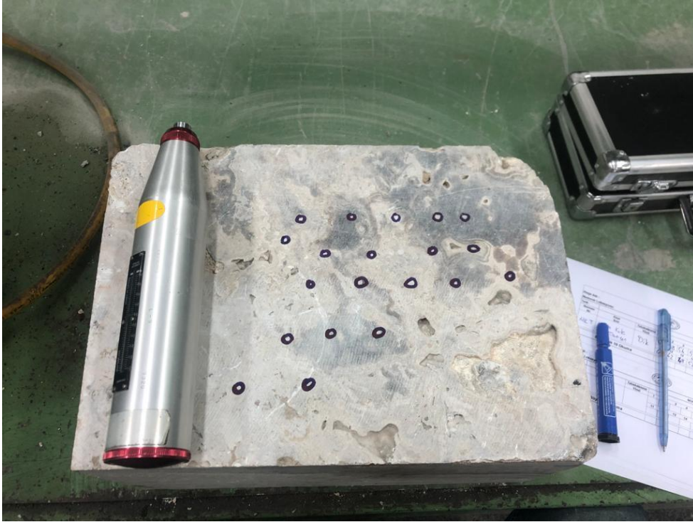
Şekil 6.14 : Schmidt deneyi yapılan noktalar.
