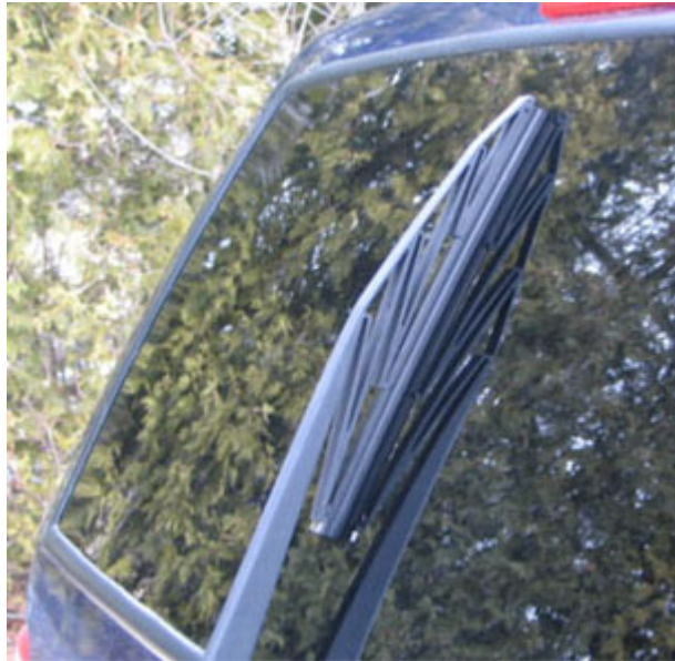
Şekil 1.10 : a) Geleneksel rijit silecek kanadı, esnek silecek kanadı ile karşılaştırılmıştır. b) Esnek silecek kanadı.
