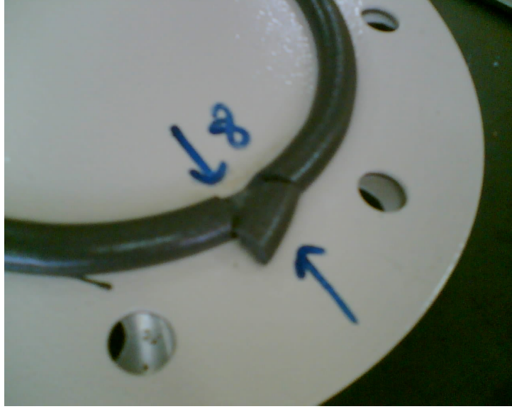
Şekil B.15 Hasar testi sonrası Numune 8’de görülen conta yırtılmaları
