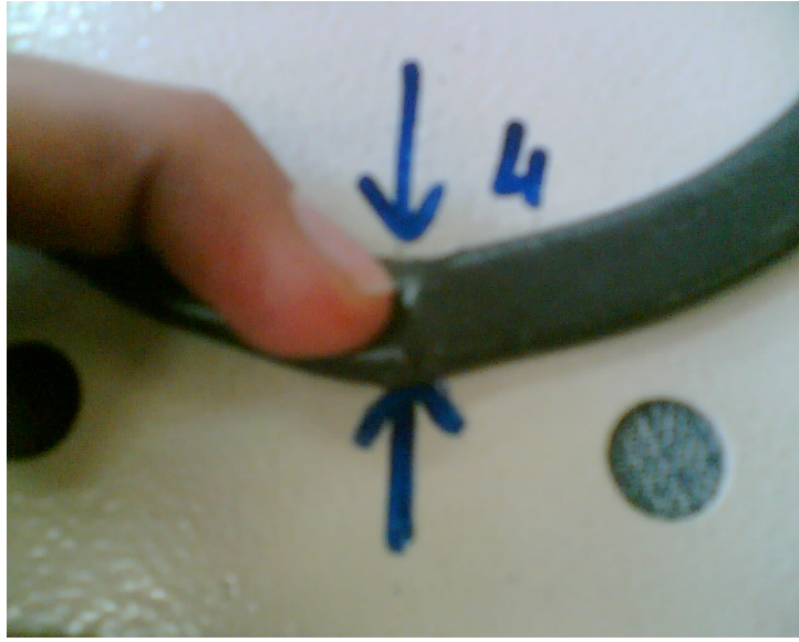
Şekil B.12 Hasar testi sonrası Numune 4’te görülen conta yırtılmaları
