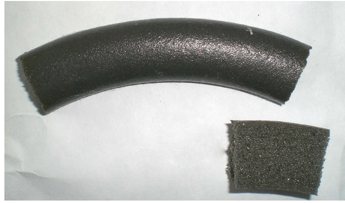
Şekil B.5 Numune 5 iç ve dış yüzeylerini gösteren kesit görünüşleri
