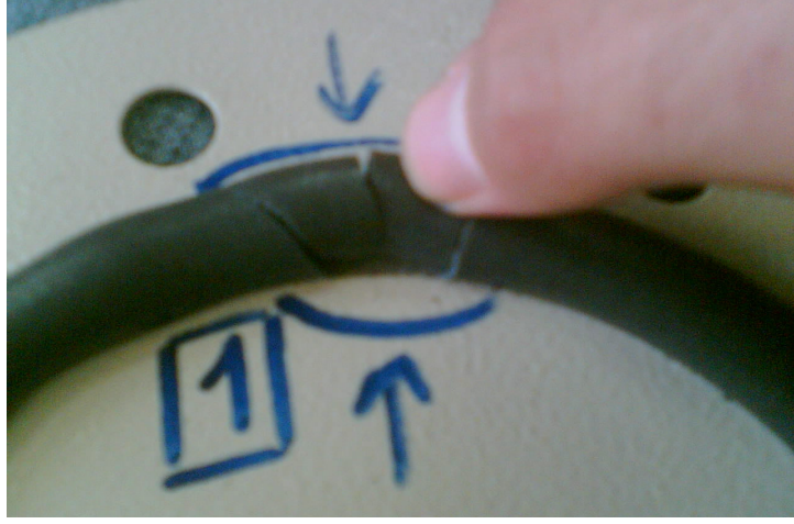
Şekil B.11 Hasar testi sonrası Numune 1’de görülen conta yırtılmaları
