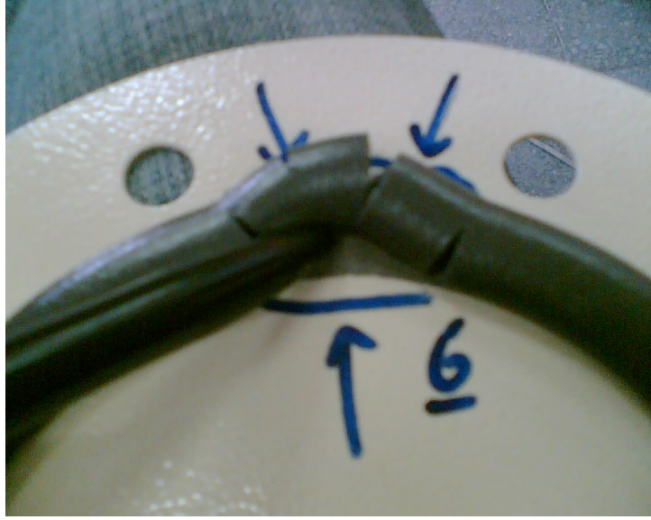
Şekil B.13 Hasar testi sonrası Numune 6’da görülen conta yırtılmaları
