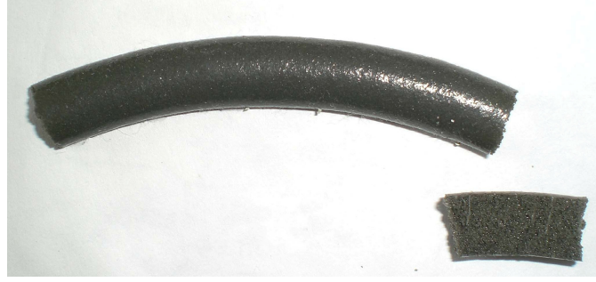
Şekil B.7 Numune 7 iç ve dış yüzeylerini gösteren kesit görünüşleri
