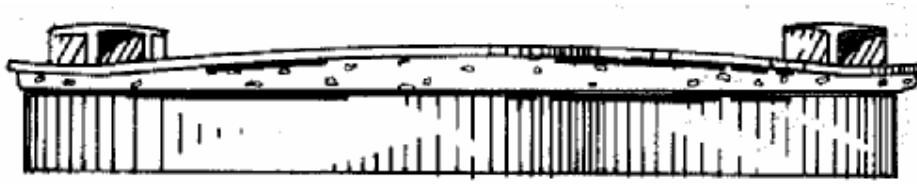
Şekil 2.10 Flanş eğilme problemi
