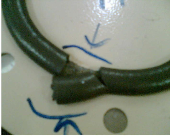
Şekil B.16 Hasar testi sonrası Numune 9’da görülen conta yırtılmaları
