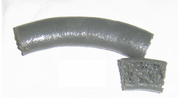
Şekil 3.5 Isıtılmış yüzeye dökülen PU conta kesidi
