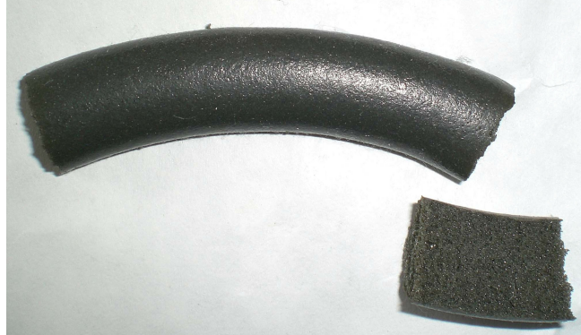
Şekil B.2 Numune 2 iç ve dış yüzeylerini gösteren kesit görüşleri
