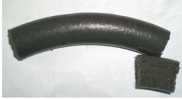
Şekil B.1 Numune 1 iç ve dış yüzeylerini gösteren kesit görüşleri
