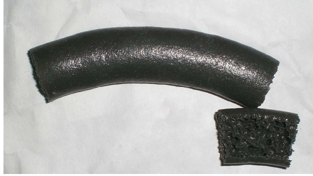
Şekil B.9 Numune 9 iç ve dış yüzeylerini gösteren kesit görünüşleri
