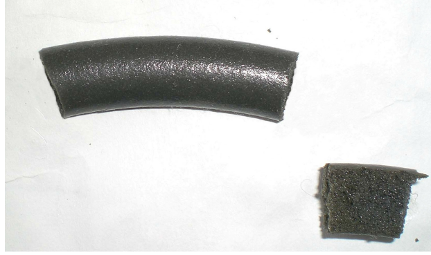
Şekil B.8 Numune 8 iç ve dış yüzeylerini gösteren kesit görünüşleri
