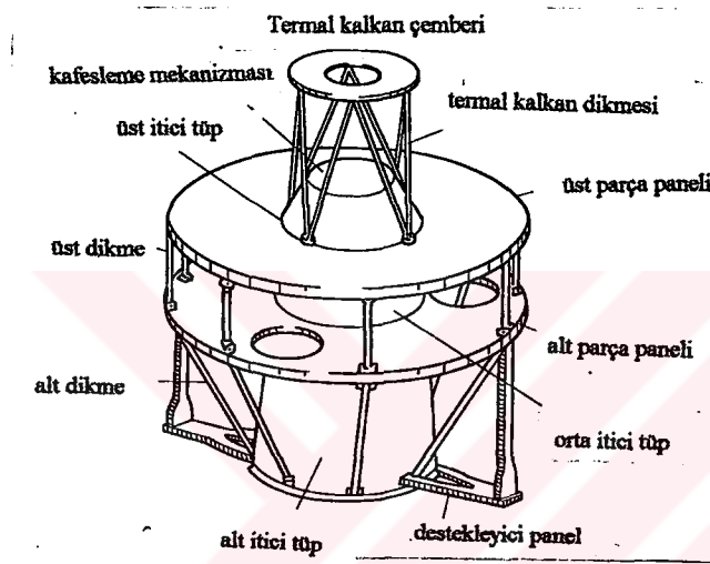
Şekil 2.14.Japon haberleşme uydusunun karbon-epoksi kullanılarak yapılmış konfigürasyonu
