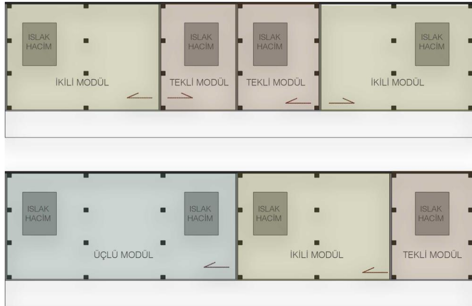
Şekil 4.13 : Modüllerin yatayda esnek olarak tasarlanma diyagramı
