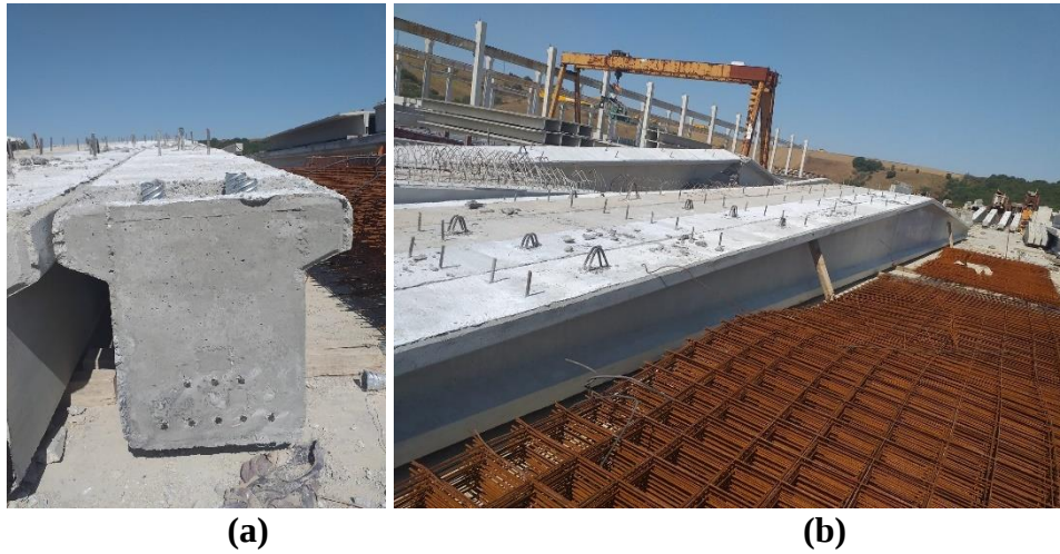
Şekil 3.11 : (a) Öngerme halatlarının kesit içindeki yerleşimi (b) Stok sahası.
