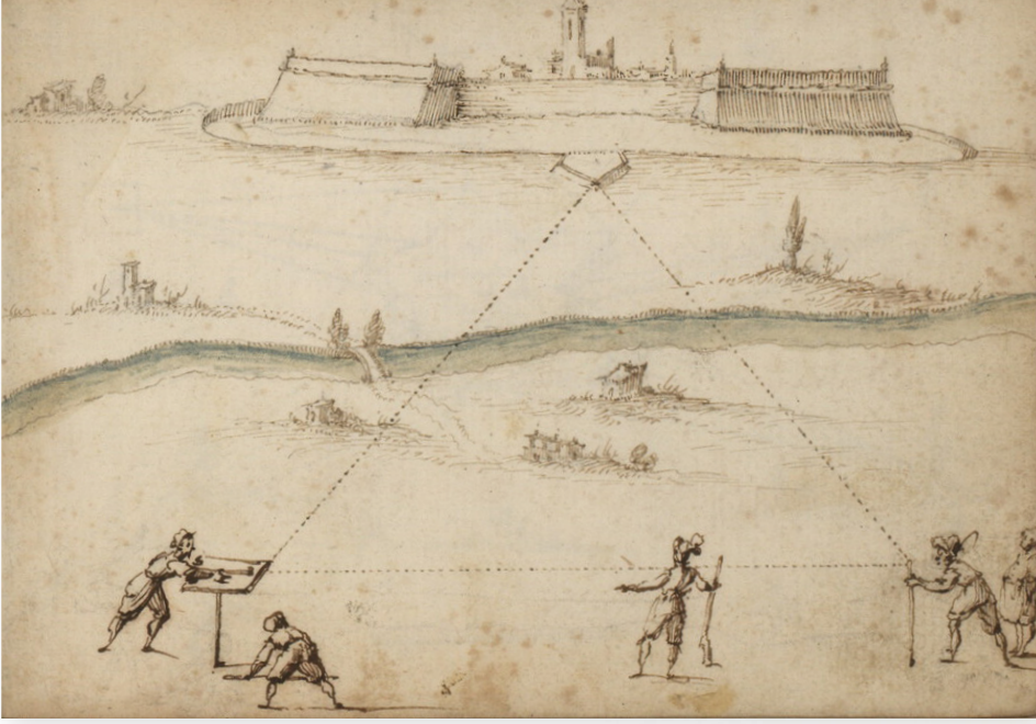
Resim 8- Ulaşılamayan uzaklıkların ölçülmesine ilişkin Fünunü'l-Harp kitabında verilen yönteme benzer Avrupa kaynaklı bir çizim
