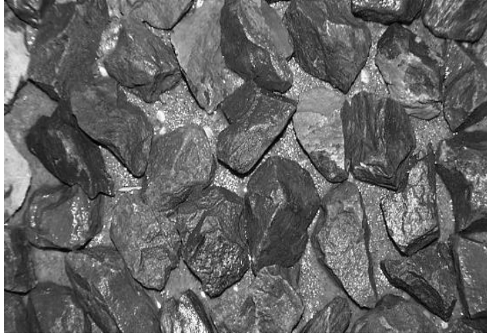
Şekil 5.25 2. Deneyin başlangıç durumda koruma tabakası yerleştirildikten sonra taban malzemesinin plan görünüşü
