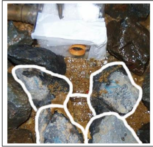
Şekil 4.6 Taş düzeneği ve video kameranın yatağa yerleştirilmiş hali
