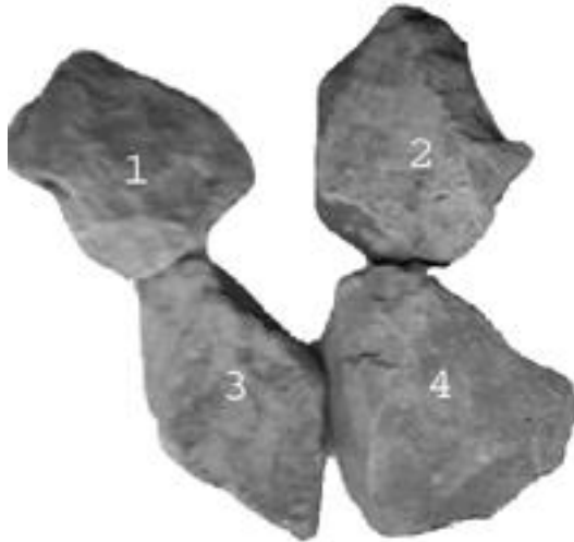
Şekil 4.5 D=3.7 cm'lik dört adet taştan oluşturulmuş deney düzeneği
