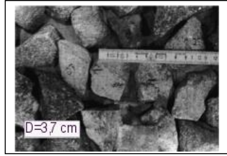
Şekil 4.2 Deneyde koruma tabakası olarak kullanılan taşlar
