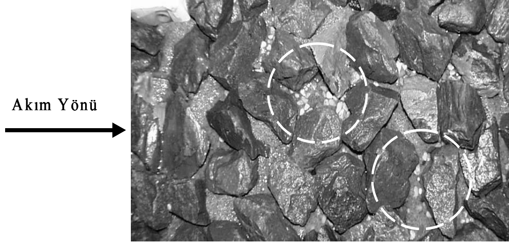
Şekil 5.26 2. Deneyin son durumda koruma tabakası altında taban malzemesinin plan görünüşü
