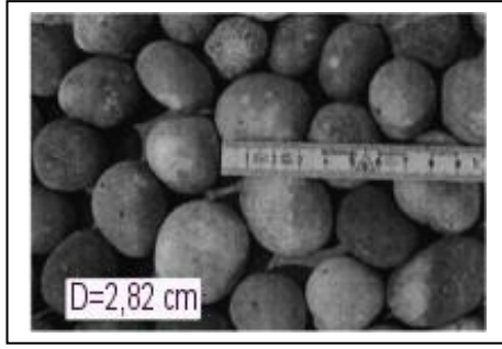
Şekil 4.2 Deneyde koruma tabakası olarak kullanılan taşlar
