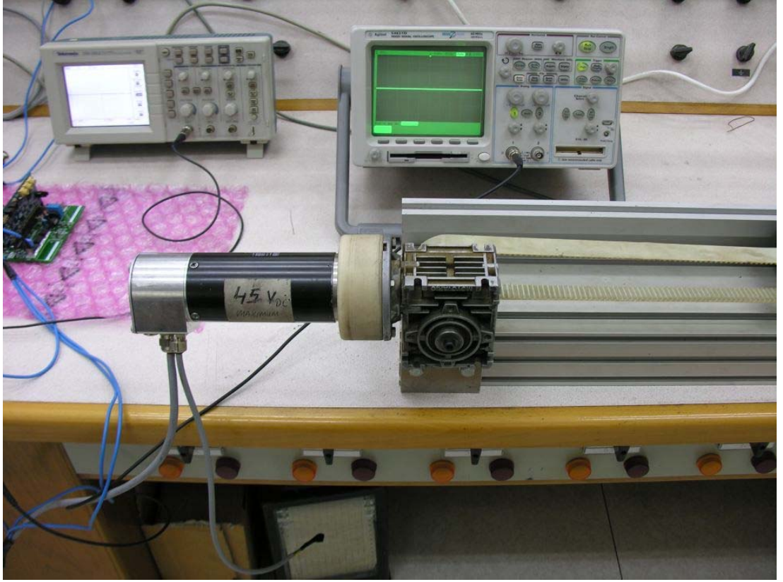
Şekil 6.6 : Pozisyonlama Tezgahı ve Motor Bağlantısı
