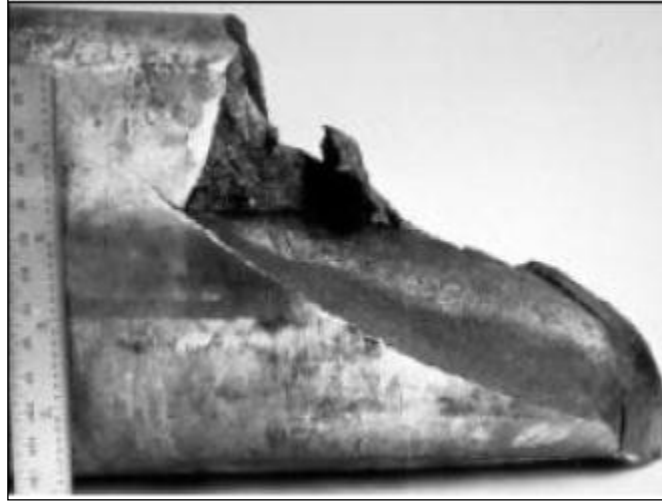
Şekil 2.4 : Bir yorulma hasar yüzeyi
