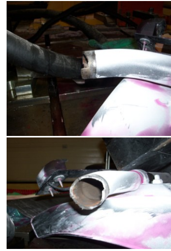
Şekil 4.38 : Titreşim kaynaklı yorulma hasarı ve laboratuvar testi hasar bölgesi.
