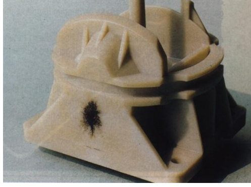
Şekil 5.1 : PA ( %30 GF) üründe oluşan yanık izi
