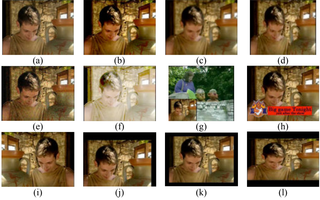
Şekil 4.2: (a) Orjinal video çerçevesi ve TRECVID testlerinde kullanılan ataklar (b) kontrast değişimi (c) bulanıklaştırma (d) yeniden kodlama (e) gürültü ekleme (f) gama bozulması (g) resim-içi-resim (h) örüntü ekleme (i) aynalama (j) kaydırma (k) kırpma (l) yeniden boyutlandırma
