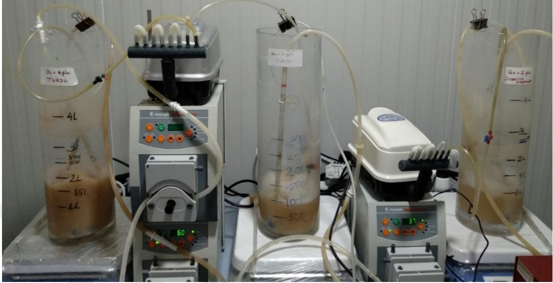
Şekil 3.4 : Çamur yaşı 6, 4, 2 gün reaktörlerinin yarı hacim görseli
