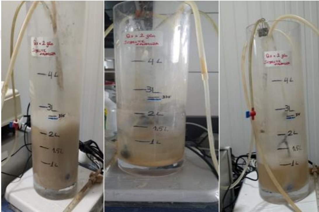
Şekil 4.11 : Çamur yaşı 2 gün reaktörü işletme görselleri
