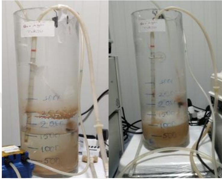
Şekil 4.6 : Çamur yaşı 4 gün olan reaktörün işletme görselleri
