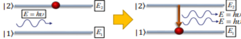
Şekil 2.5 : İki enerji seviyeli bir sistemde uyarılmış emisyon [19].
