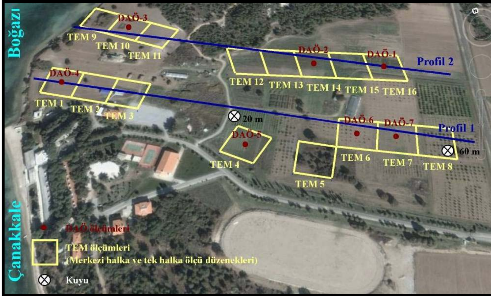
Şekil 6.4 : Çanakkale, Dardanos yerleşkesinde TEM ve DAÖ ölçüm noktalarını ve çalışma alanında açılmış 2 adet su kuyusunun yerlerini gösteren lokasyon haritası.
