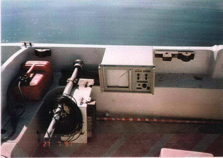
Şekil 5.6. Ölçmelerde Kullanılan Atlas Deso-15 Derinlik Ölçerinin Görünümü
