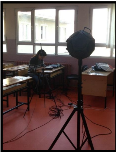
Şekil 3.6 : PHG Okulu 3B/7B sınıfı kaynak ve alıcı yerleşimi.
