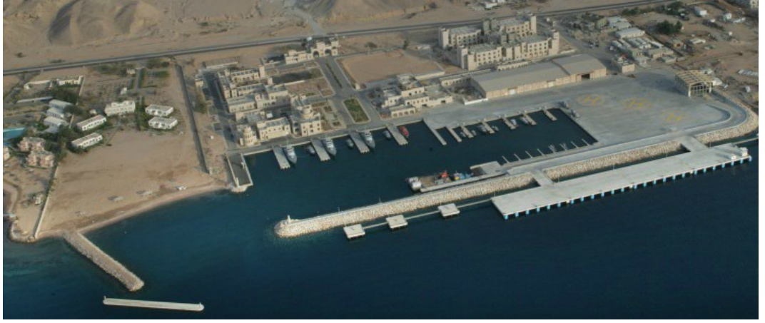
řekil 1.7: rdn Aqaba'da liman ii alkantıyı nleme amalı yapılmıř bir dalgakıran.
