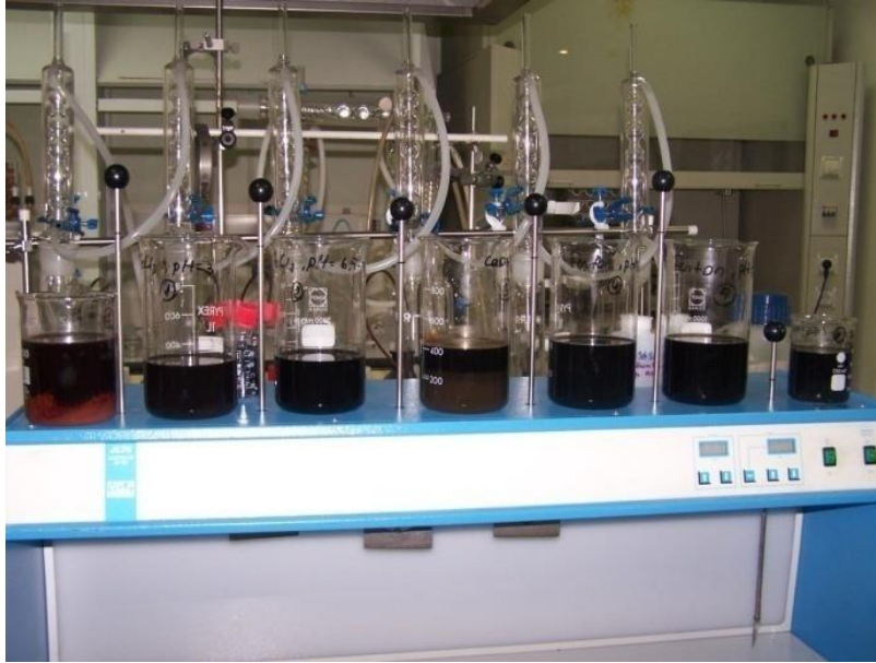
Şekil A.1 : Çalışılan kimyasal arıtma prosesleri, sol baştan sırasıyla asit kraking, pH 3,0 değerinde FeCl_3 ile koagülasyon, pH 6,5-7,0 değerinde FeCl_3 ile koagülasyon, Ca(OH)_2 ile çöktürme, Fenton prosesi (pH=3), Fenton prosesi (pH=2)
