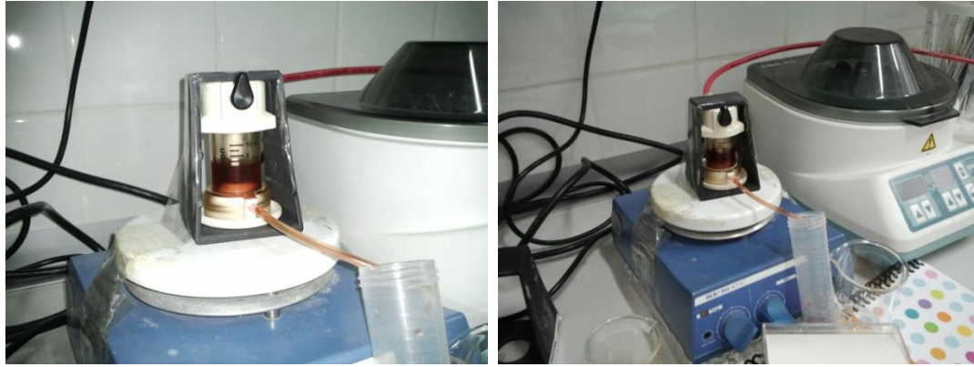
Şekil 3.1 : Boyutsal fraksiyonlama çalışmalarında kullanılan ultrafiltrasyon seti.
