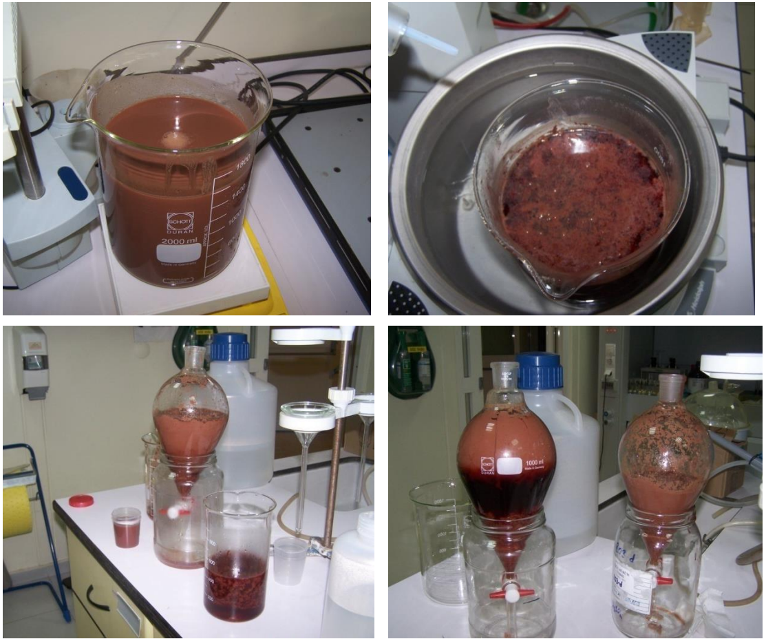
Şekil 5.9 : Karasuyun asit kraking prosesi ile arıtımı (pH=2,0, T= 70°C, t=60 dk).
