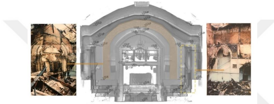
Şekil 4.44: Elhamra Sineması'nın deprem sonrası görselleri (Harita Yüksek Mühendisi Alper Yiğitoğlu tarafından hazırlanan üç boyutlu lazer tarama ölçümü ile rölöve çalışması, İstanbul mevcut gece kulübü enine kesit ve İstanbul 2 Numaralı Kültür Varlıklarını Koruma Bölge Kurulu arşivinde bulunan yangın sonrası fotoğraflardan türetilmiştir.).
