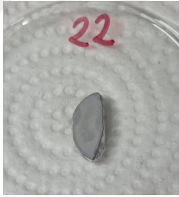
Şekil 4.18 : 30°C'de Pd kaplanmış membranın UiO-66 büyütmesi sonrası üstten görünümü.
