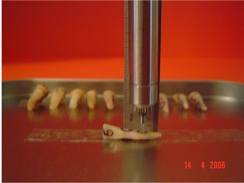
řekil 4.13 VersaWawe Er:YAG 2940 Laser Cihazı ile Yapılan Deneysel alıřmalarda Kullanılan Düzenek ve Geometri
