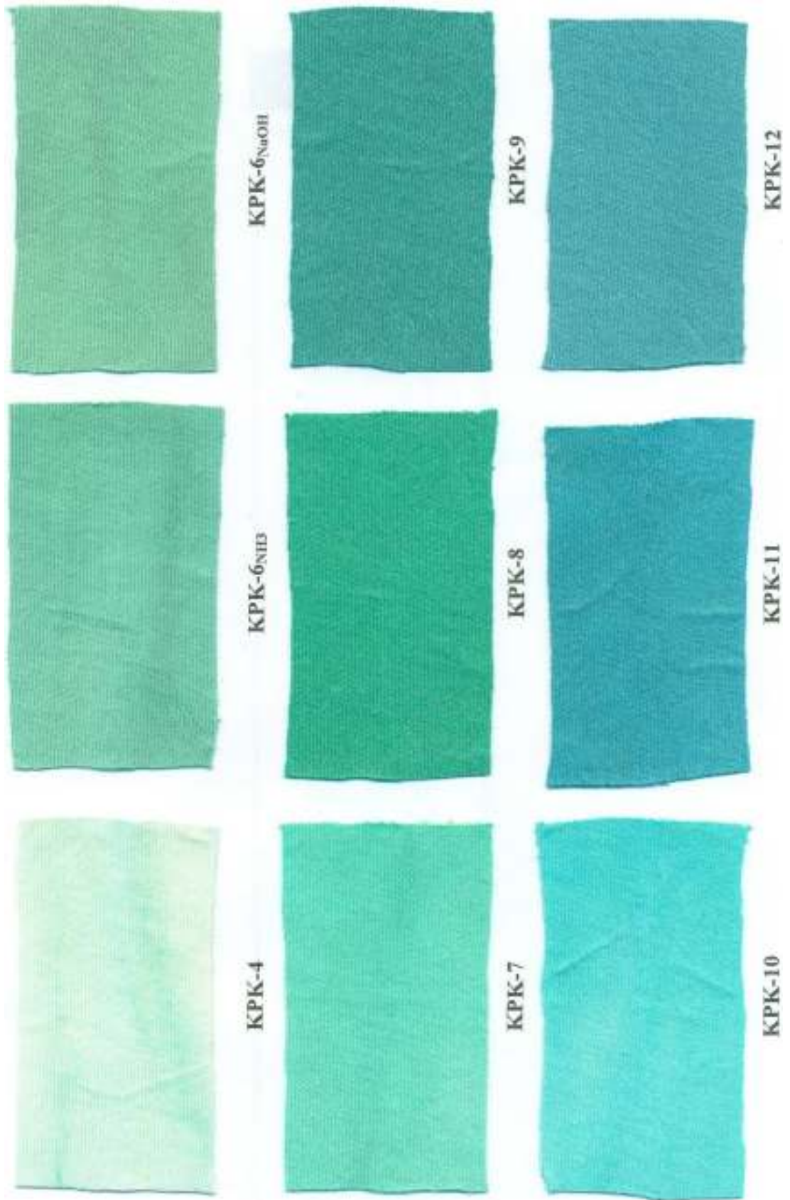
Şekil 6.5: MPc ile boyanan katyonik pamuk kumaşlar.
